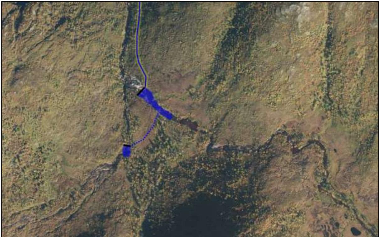
FIGUR 6: FLYFOTO MED HOVEDINNTAK OG BEKKEINNTAK INNTEGNET. TRASE FOR OVERFØRING OG RØRGATE ER OGSÅ MARKERT (REFERANSE 3).
