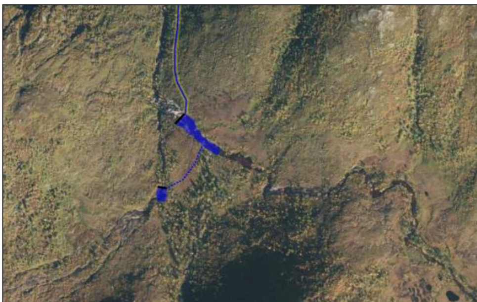
Figur 1. Flyfoto med hovedinntak, bekkeinntak og overføringsrør inntegnet.
