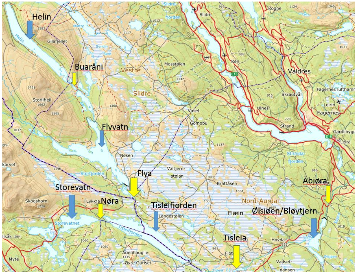
Figur 2: Oversikt over Åbjøravassdraget. Blå piler viser reguleringsmagasin. Gule piler viser påvirkede elvestrekninger.
