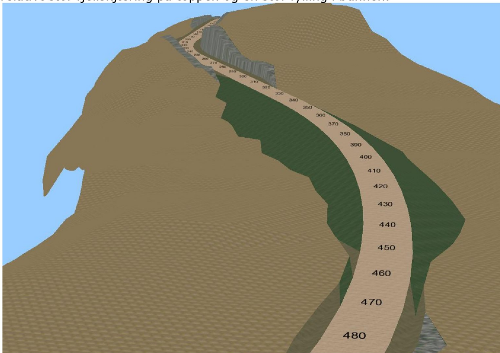
Figur 1: Vegen sett vestfra. Profil 480 og bakover. Legg merke til stor fylling og tosidig fjellskjæring.
