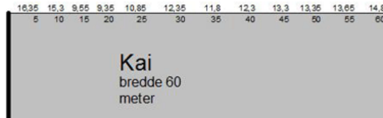
Figur 2: Dybdemålinger kaifront Langsetvågen industriområde, dybder angitt ved lavvann
