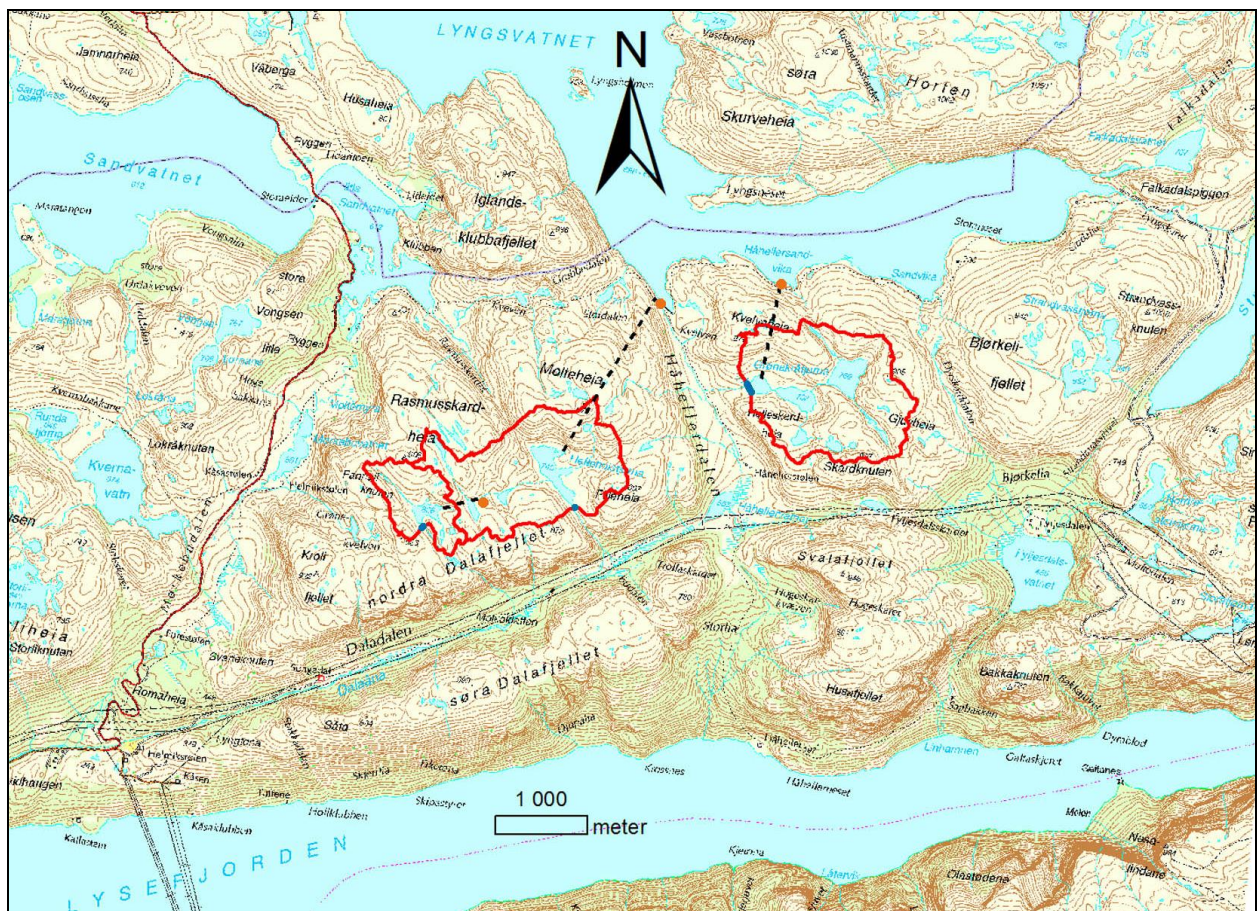
Figur 4-3 Illustrasjonen viser tiltakets bestanddeler: Stiplede linjer viser overføringstunneler i fjell, oransje markering viser massedeposier, blå markering angir damkroner. I tillegg er nedbørfeltene markert med rødt. Kartgrunnlag: Statens kartverk.
