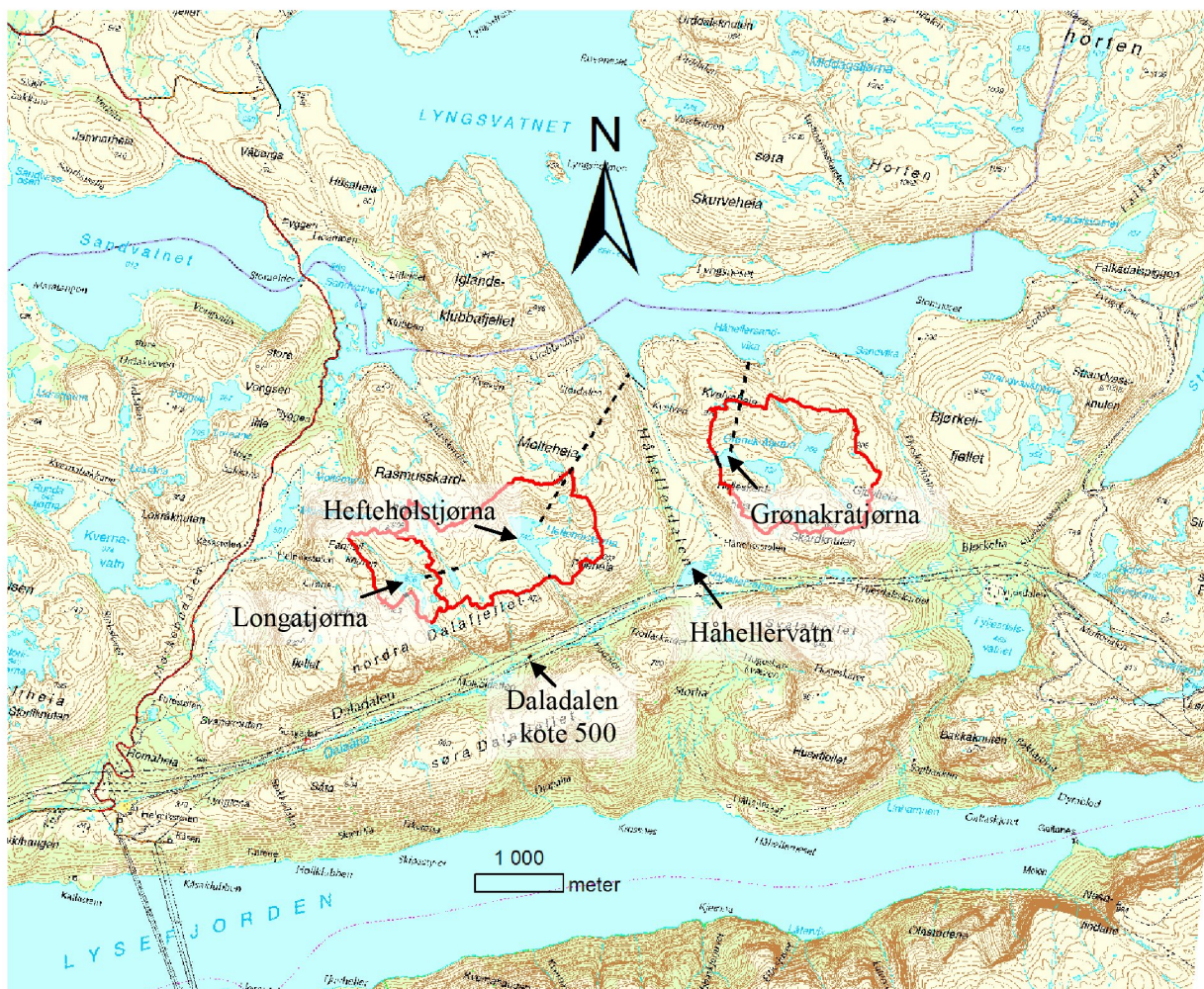
Figur 2-1 Geografisk beliggenhet av tiltaksområdet. Nedbørfeltene til Longatjørna (til venstre), Hefteholstjørna (i midten) og Grønkråttjørna (til høyre) er avgrenset med rødt, overføringstunneler er vist med stiplede linjer.
