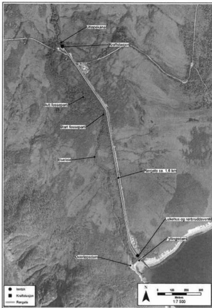
Figur 2: Detaljkart over Lovik kraftstasjon
