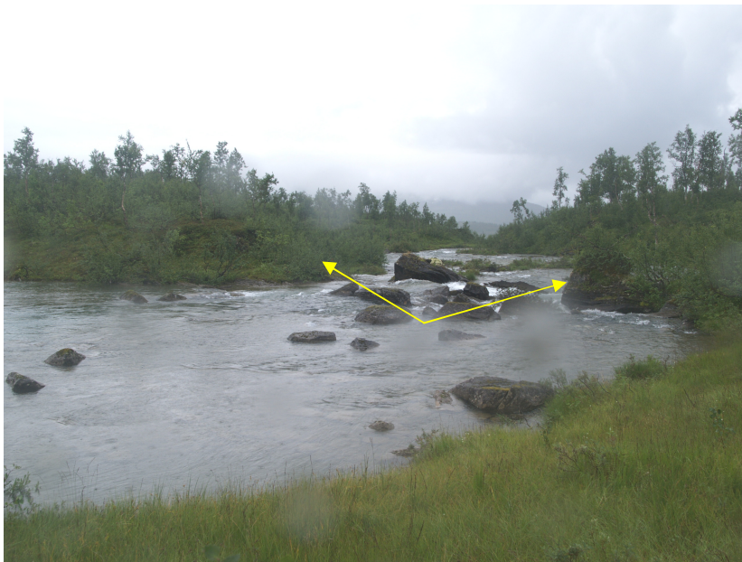
Figur 2-4 Mulig damplassering på kote 530, nedenfor utløpet av Grønvatnet.
