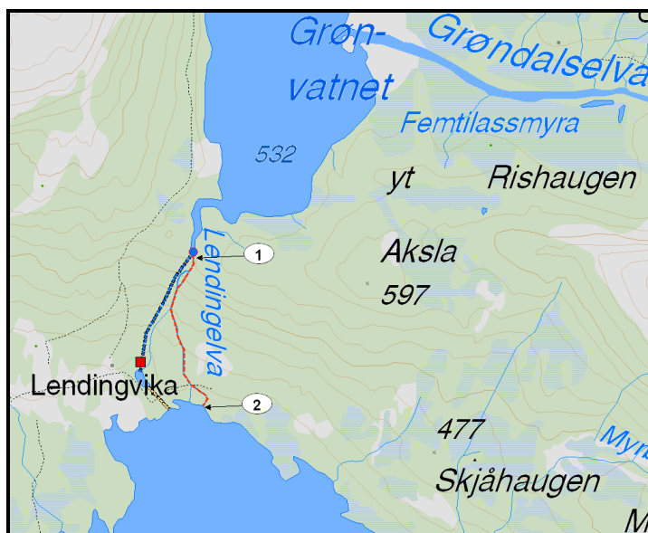
Figur 3-1 Kartskisse over planlagt tiltak. Inntak er vist som blå sirkel og kraftverk som rød firkant. Berørt hovedelvestrekning er stiplet rød.
