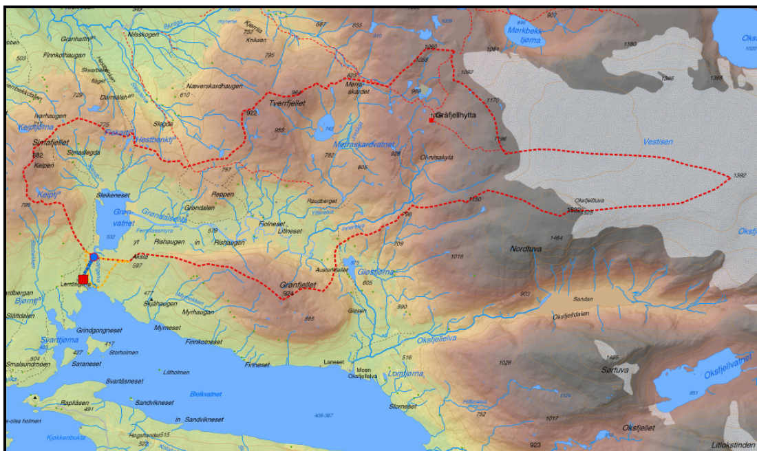
Figur 2-1 Oversiktskart over nedbørsfelt. Inntaksfelt er stiptet rødt, restfelt i oransje. Vannvei er antatt.
