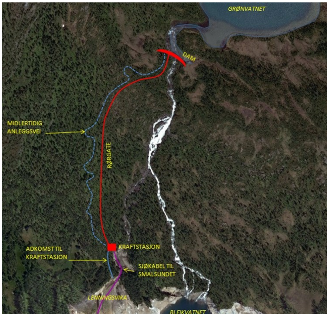
Figur 2 Detaljkart over Lendingelva kraftverk (fra konsesjonssøknad).
