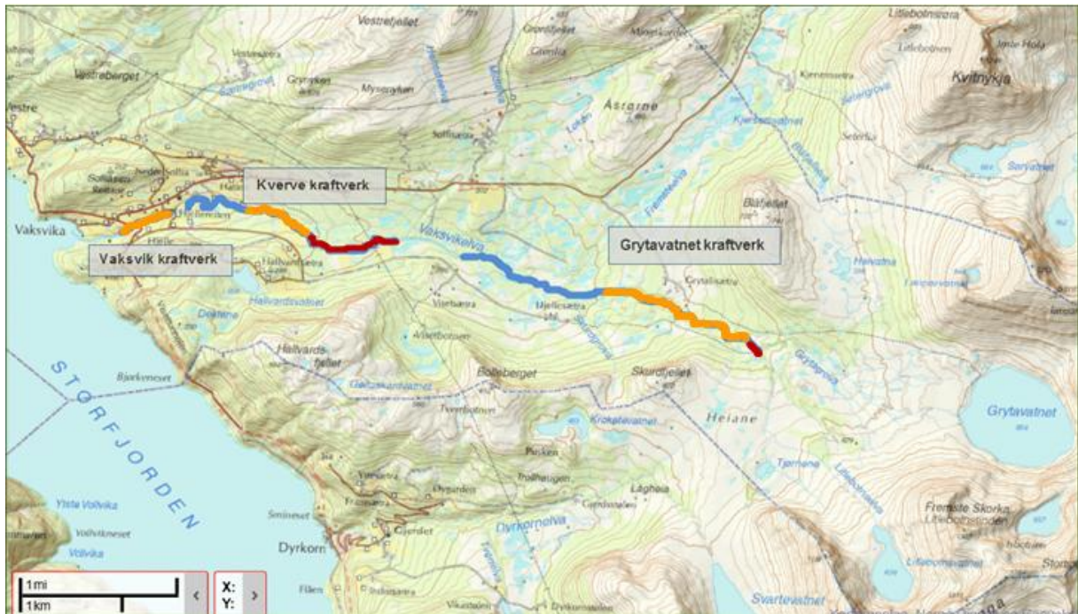
Figur 3.20.2 Tre påverka elvestrekningar. Raudt = minstevassføring åleine, oransje = noko bidrag får restfelt / mange dagar med stans i drift og blå = stor restvassføring og / eller godt dekt elveareal ved kraftverk i drift.
