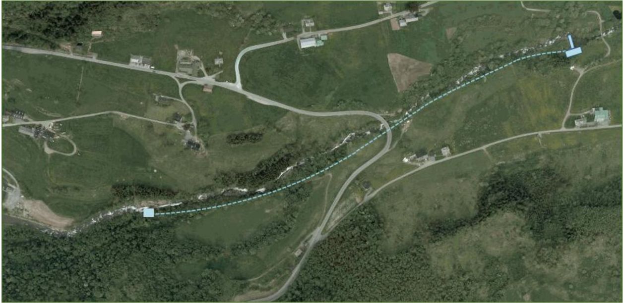
Figur 2.2.5.1 Rørtrase vist på luftfoto.
