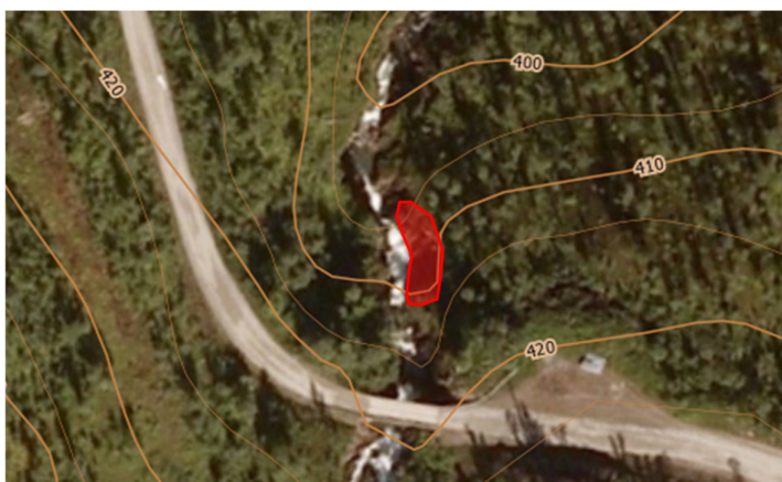
Figur 3-11. Fossesprøytsone ved kote 410.
