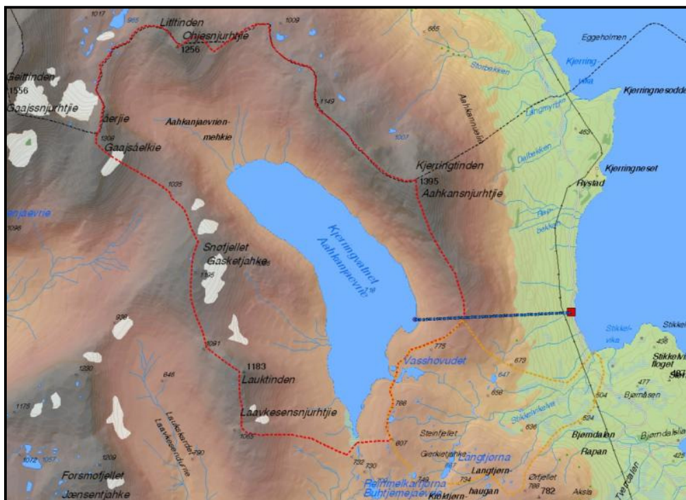
Figur 2-2. Oversiktskart over nedbørfelt. Inntaksfelt er stiplert rødt, restfelt i oransje. Kart: Sweco Norge AS.
