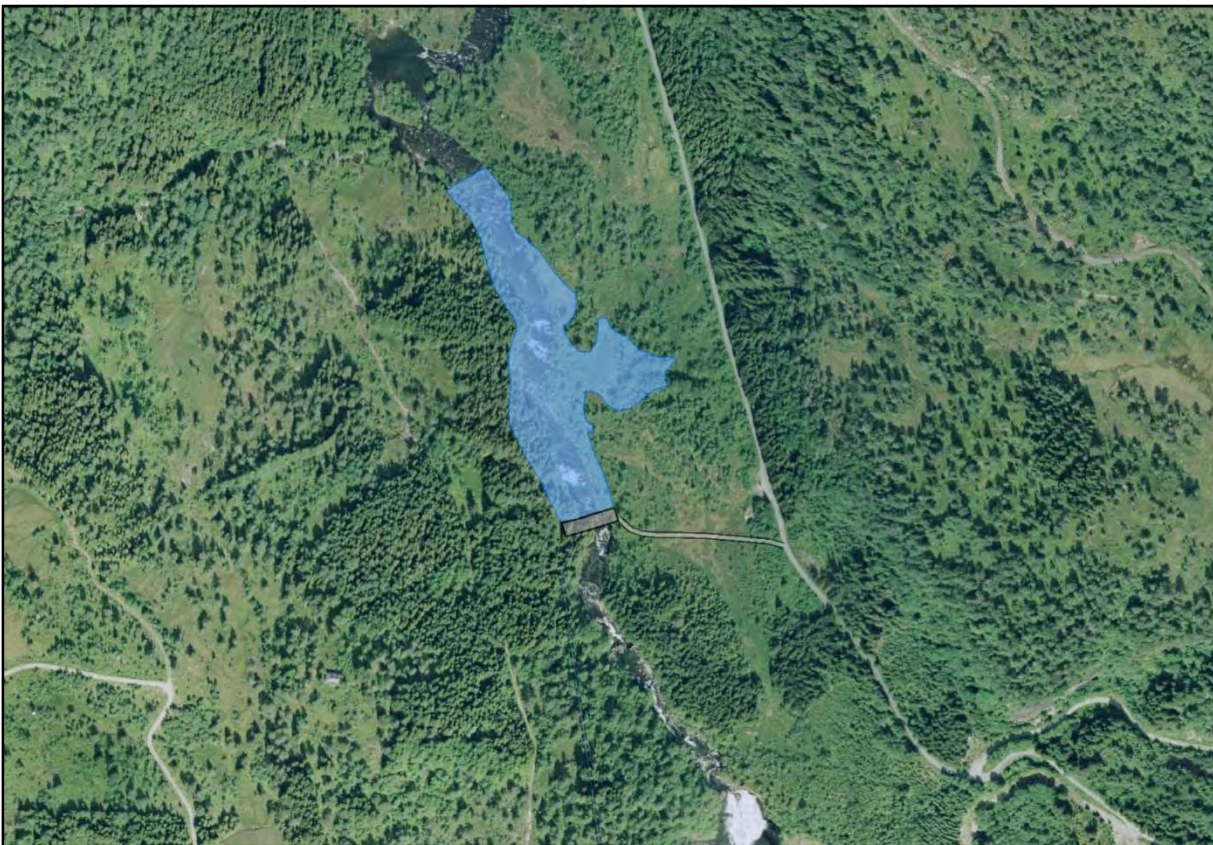
Figur 21. Ortofoto som viser inntaksbassengets omtrentlige utstrekning. Inntaksbassengets lengde er på ca. 270 m, mens bredden varierer fra ca. 30 til ca. 120 m (snitt ca 55 m).
