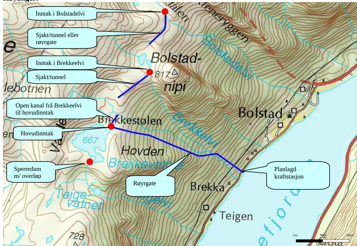
Figur 3. Kartutsnittet viser i grove trekk dei viktigaste naturinngrepa i form av inntak, rørgater, tunnelar og kraftstasjon.
