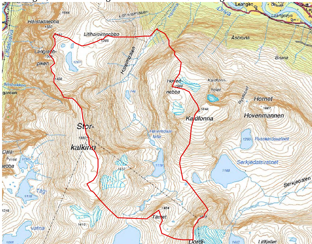
Figur 5: Kartet viser inntegnet nedbørfelt for Hareima med antatt inntak kote 540. Kartet er hentet fra hydrologisk rapport utarbeidet av NVE (Bache Stranden 2008).
