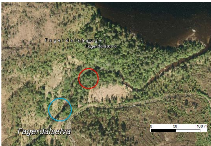
Figur 11. Rød sirkel viser område for planlagt utløp fra kraftverket, mens blå sirkel viser området av elva som ligger mellom ca. 360-400 m oppstrøms utløpet, og dermed i øvre del av strekningen tilgjengelig for ørret fra Slørdalsvatnet.
