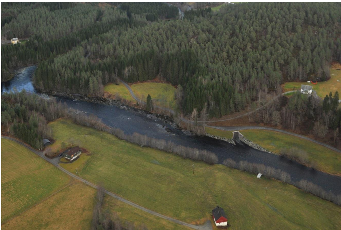
Figur 3-3. Avløpstunellen ender skrått vinklet nedstrøms. Her oppstår en kulp som strekker seg et stykke oppstrøms.
