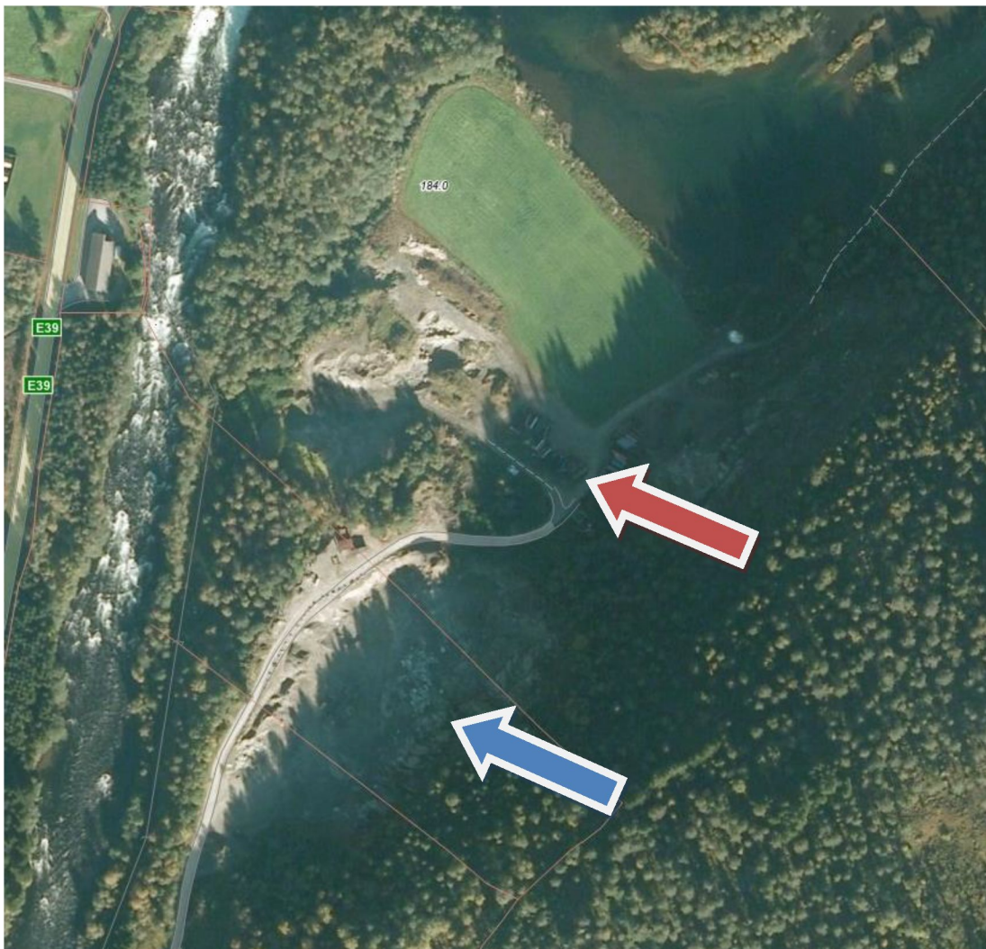
Fig.1: Flybilette over grusuttaket ved Nesbakkane. Nydyrka grønt areal er tidlegare oråde for sand og grus. Område lengre mot sør viser eit uttaksområde som nærmer seg slutten. Området blir gjort klart for planering og attsåing til eng. Raud pil. Blå pil peiker mot kraterområdet, der ein har kome ned mot elvenivå.
