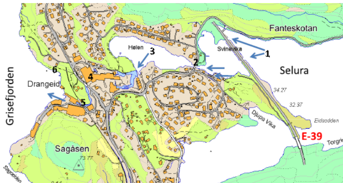
Figur 2 gir en oversikt for vannets vei fra Selura til Grisefjorden. Punkt nr. 1 angir kulvertpassasjer under E 39 til Svinevika. Punkt nr 2 viser terskelkanalen til Hølen. Punkt nr 3 området for damanlegg. Selurelva vises med blått. Punkt nr 4 angir fabrikkområde, punkt nr 5 beliggenheten til gammel kraftstasjon, jernbane og næringsbygg mens punkt nr 6 viser planlagt område for ny kraftstasjon.
