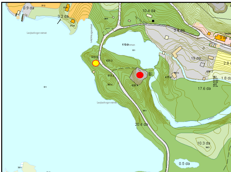
Figur 6: Arealbruk på grunnvannsforekomsten domineres av skog (grønn farge). Dagens produksjonsbrønner er vist med gul og rød farge.
