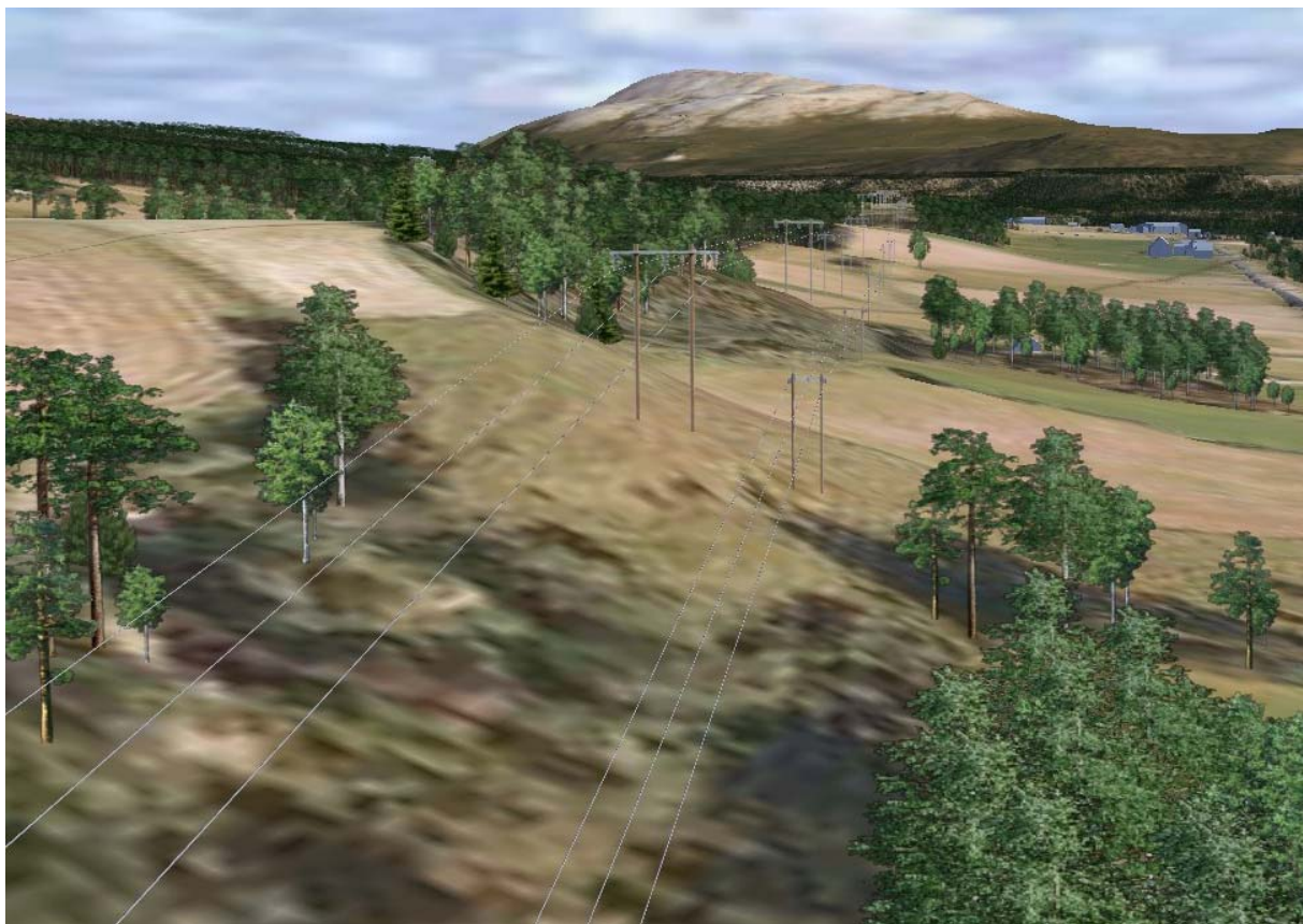
Figur 4.3 Fra 3D-modell. For alle utbyggingsalternativer innebærer nettilknytningen at betydelige deler av 132 kV kraftledningen fra kraftverket vil bli parallellført med bestående 22 kV ledning. Planlagt 132 kV ledning står her til venstre for bestående 22 kV ledning. Oppe i figurens høyre hjørne kan bebyggelsen på gården Mojordet og Lensmannsgården skimtes.
