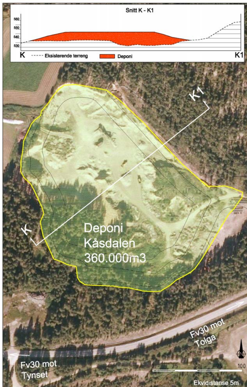
Figur 2.10 Deponi Kåsdalen ved utbyggingsalternativ 2A, som er det alternativet som gir det største deponivolumet her for utbyggingsalternativ 2A/2B (Feste NordØst as 2012).
