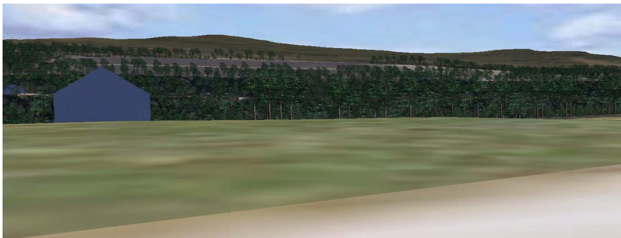
Bilde 1. Fra 3D-modell. Ståsted fra fylkesvei 30, sør for Lennsmannsgården, mot deponi Brennmoen (alternativ 2A og 2B – 430 000 m 3 ) i anleggs- og tidlig driftsfase. Deponiet blir godt synlig i anleggsperioden fra flere strekninger på fylkesvei 30. Vegetasjonsetablering vil i stor grad dempe synligheten.
