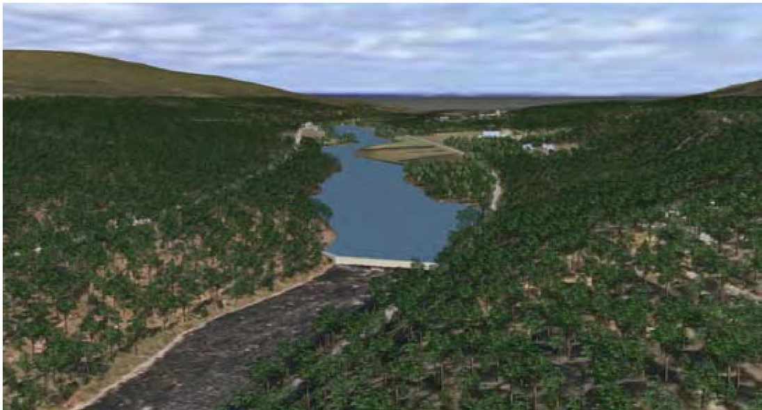
Bilde19. Fra 3D-modell. Elvestrekningen som omfattes av dam og vannmagasin ved Hummelvoll. Øverst: Dagens situasjon. Nederst: Fremtidig situasjon når dammen er bygget og vannmagasinet er etablert.
