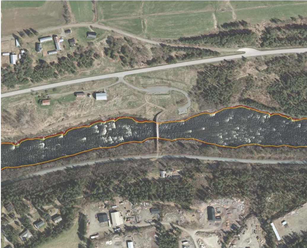
Bilde 17. Vannkantlinjer fra området ved Gammelbrua. Vannføringen i elva er 92 \text{ m}^3/\text{s} . Rød strek viser vannkant ved 18 \text{ m}^3/\text{s} vannføring. Gul strek viser beregnet vannkant ved 5 \text{ m}^3/\text{s} vannføring.
