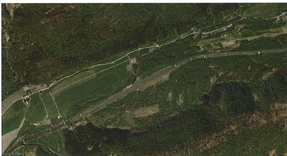
Bilde 2: Bævrå er kanalisert og det er bygd terskler over en strekning på cirka 5 km
