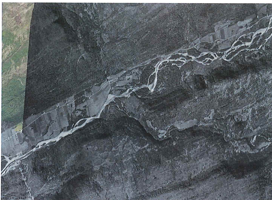
Bilde 3: Bildet viser kanalisert strekning i Bævrå, slik det var før kanaliseringen (foto fra 1963)
