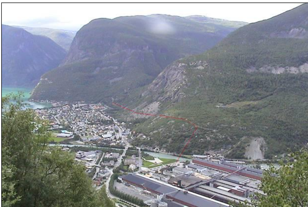
Figur 3. Øverst: Oversiktskart over planlagt nettilkopling til eksisterende 22 kV nett, via en 1,4 km lang ny linje (rød) og en 1,0 km lang jordkabel (brun). Nederst: Luftlinjetraséen (rødt) tegnet inn på foto.
