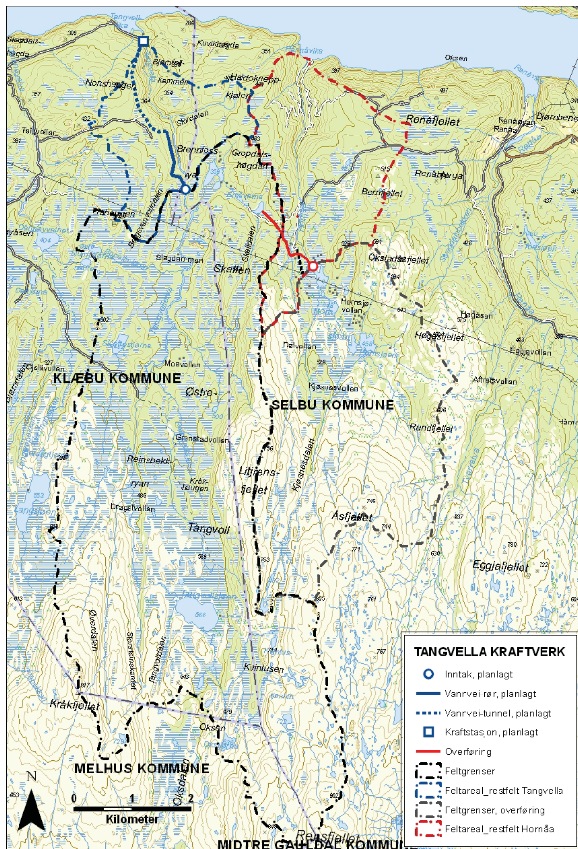
Figur 2 Kart over tiltaket med nedbørfelt og restfelt
