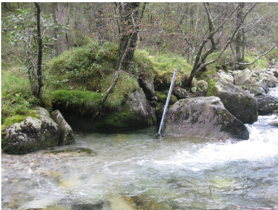
Figur 30 Vannstandslogger av typen Global Water, på kt. 220 (Foto: Elvekraft, 2009).
