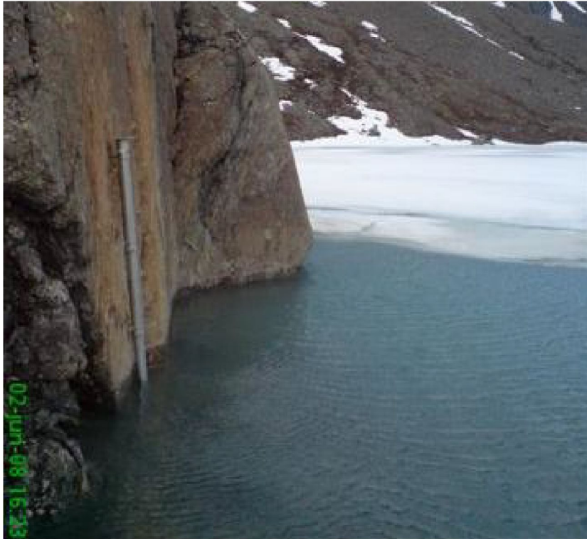
Vannmåler montert i utløpet til Første Vittnesvatn. Foto: Elvekraft
