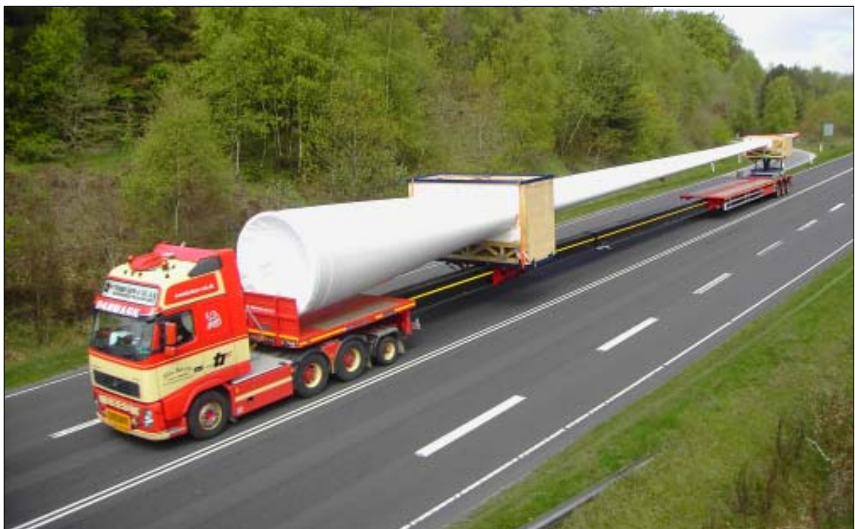
Figur 10. Frakt av rotorblad stiller store krav både til kjøretøy og infrastruktur (horisontal- og vertikal- radius på veier).
