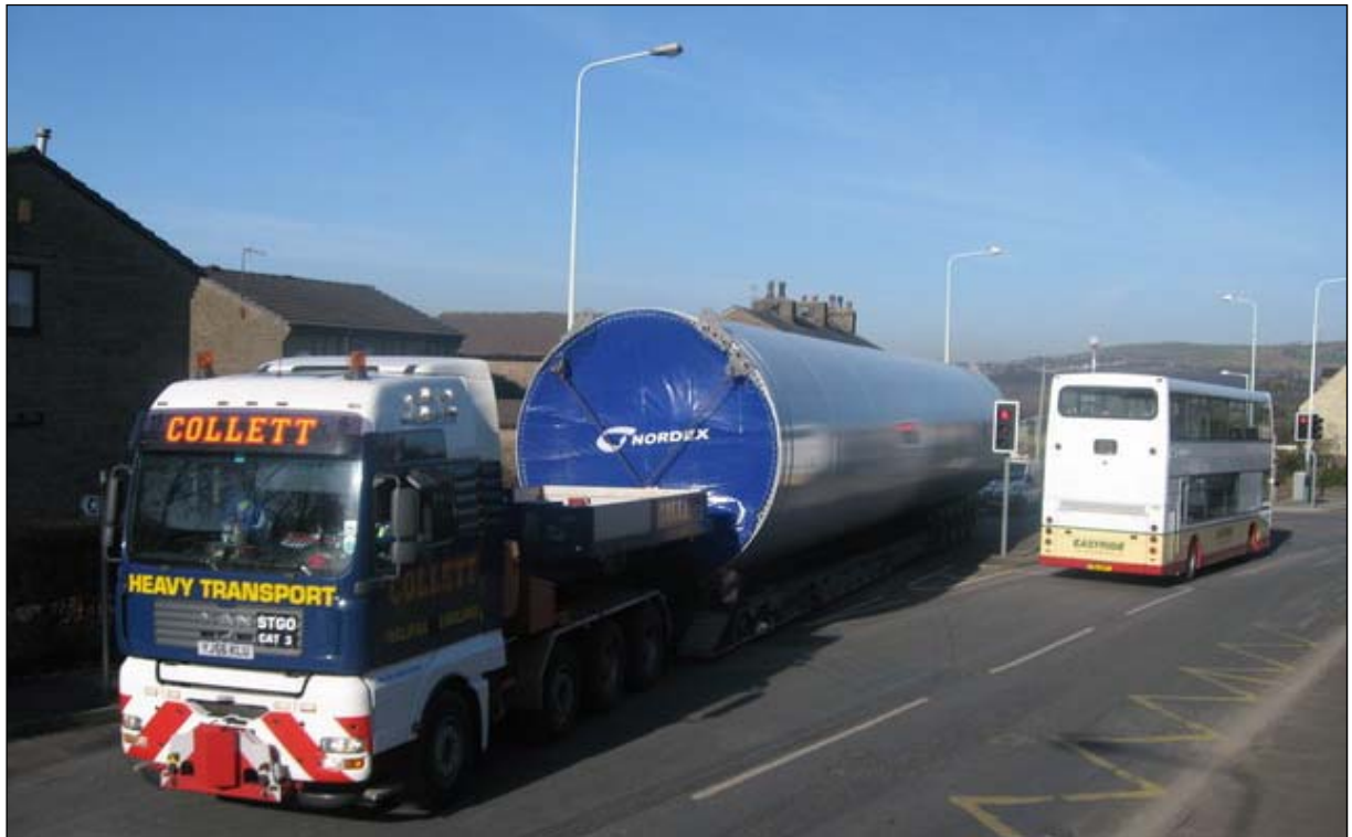
Figur 9. Frakt av turbinmoduler, og spesielt tårn, krever en frihøyde på 4,4 – 5,9 m, noe avhengig av transportmetode /type kjøretøy). Foto: Nordex.
