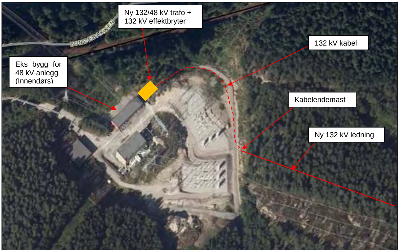
Figur 9. Oversikt omsøkt løsning inne på Halden sentralnettstasjon.
