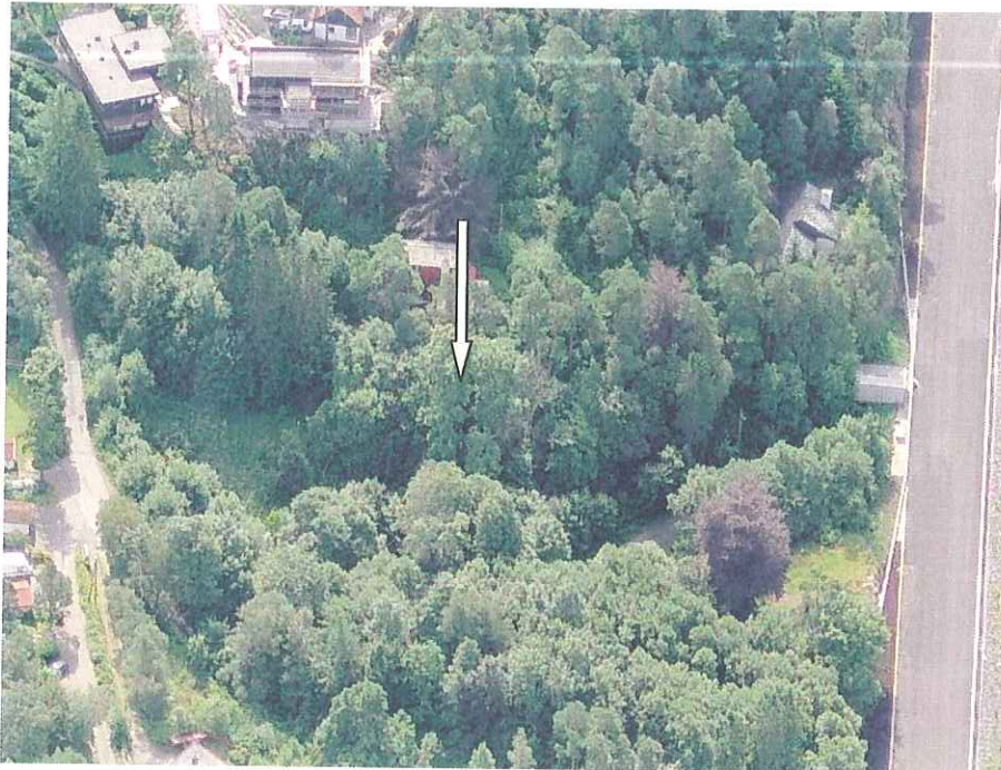
Figur 10 Flyfoto viser området for påhugg av tverrslaget i Skiparvika. Det tett skog i området som gjør at en ikke ser skjæringen for planlagt påhugg. Flyfoto sett mot sør.
