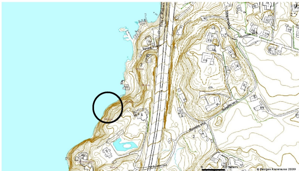
Fig. 7 Anbefalt plassering av utløp fra flomtunnel.
