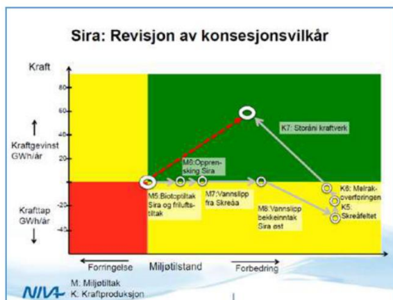
Figur 1. Planer for ny vannkraftproduksjon og miljøtiltak i Sira-Kvina vassdraget skisserer miljøtiltak og ny vannkraftproduksjon som samlet skal gi en vinn-vinn gevinst som angitt i NIVA sine modeller for hhv Kvina og Sira. Merk: Kraftverksprosjekt K3 Stakkeland og K5 Skredfjeldet er ikke lengre aktuelle.
