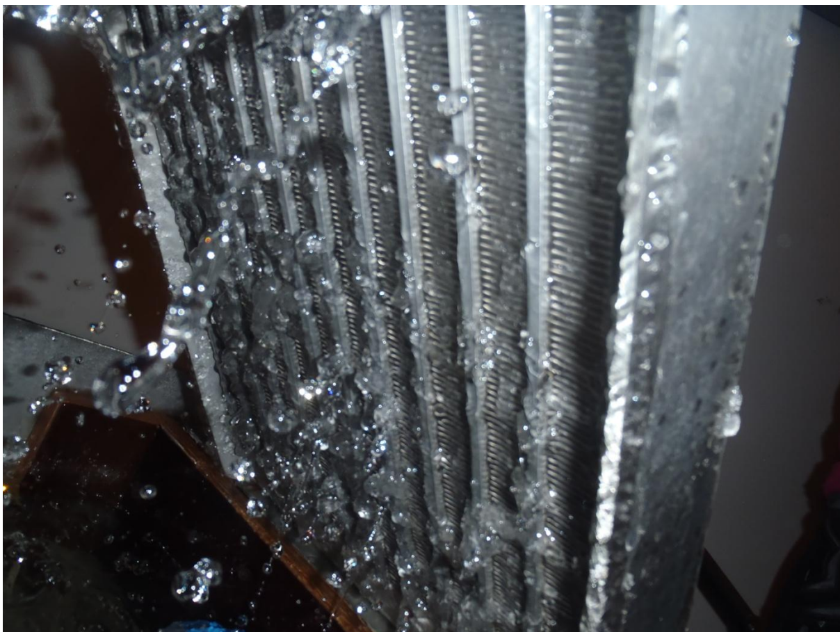
Figur 45: Bakside av rist ved forsøk -10 C (Foto: H. Opaker)
