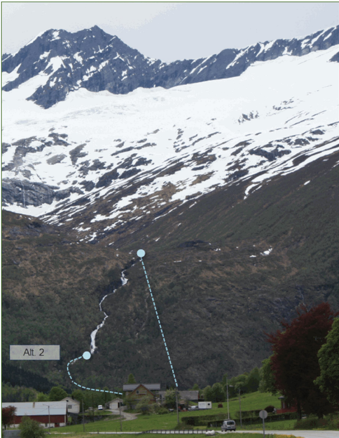
Figur 2.2.5.1 Strekning for bora vassveg (hovedalternativet) og rørtrase for alt. 2.
