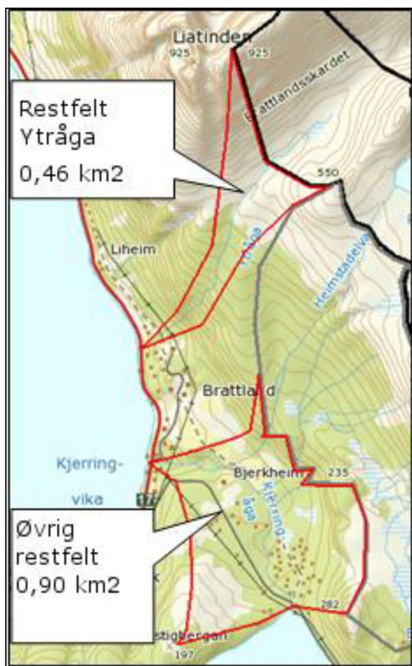
FIGUR 7. RESTFELT KJERRINGÅGA KRAFTVERK.
