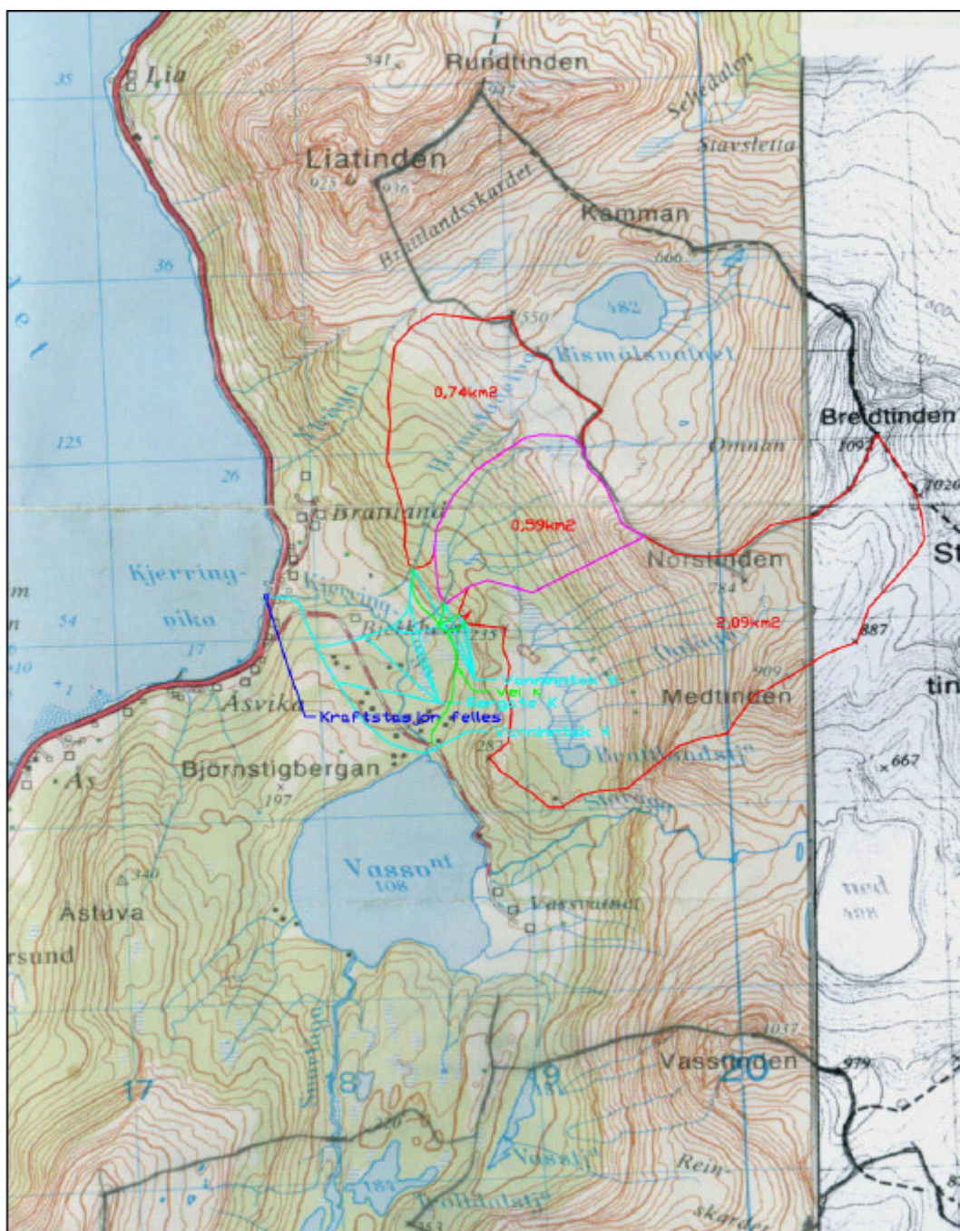
Figur 2. Kart som viser lokalisering av planlagte installasjoner. Turkis linje viser rørgater, mens grønne linjer viser nye permanente adkomstveier. Rød/lilla markering viser nedbørsfelt
