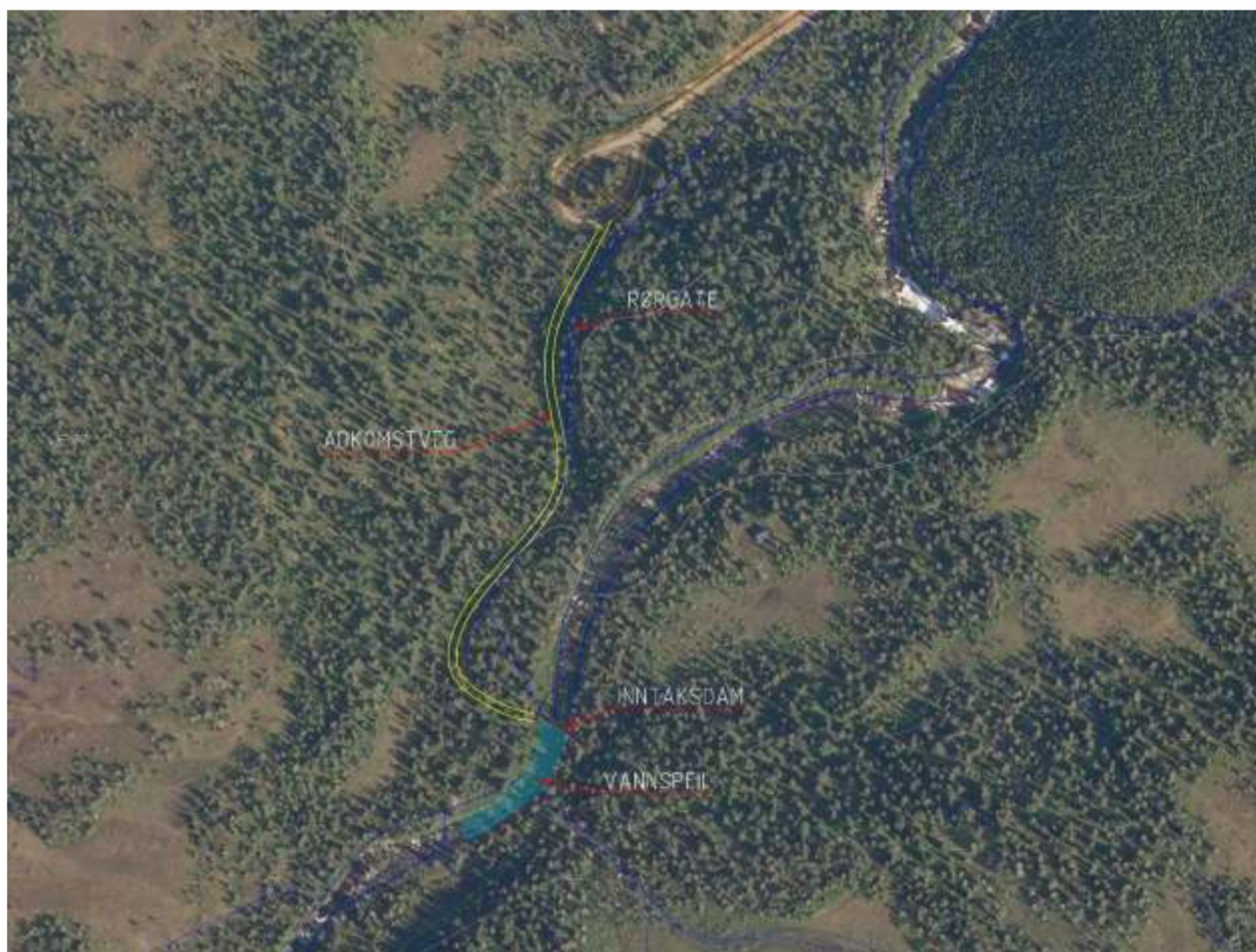
Figur 6 Prinsippskisse for utforming av inntak
