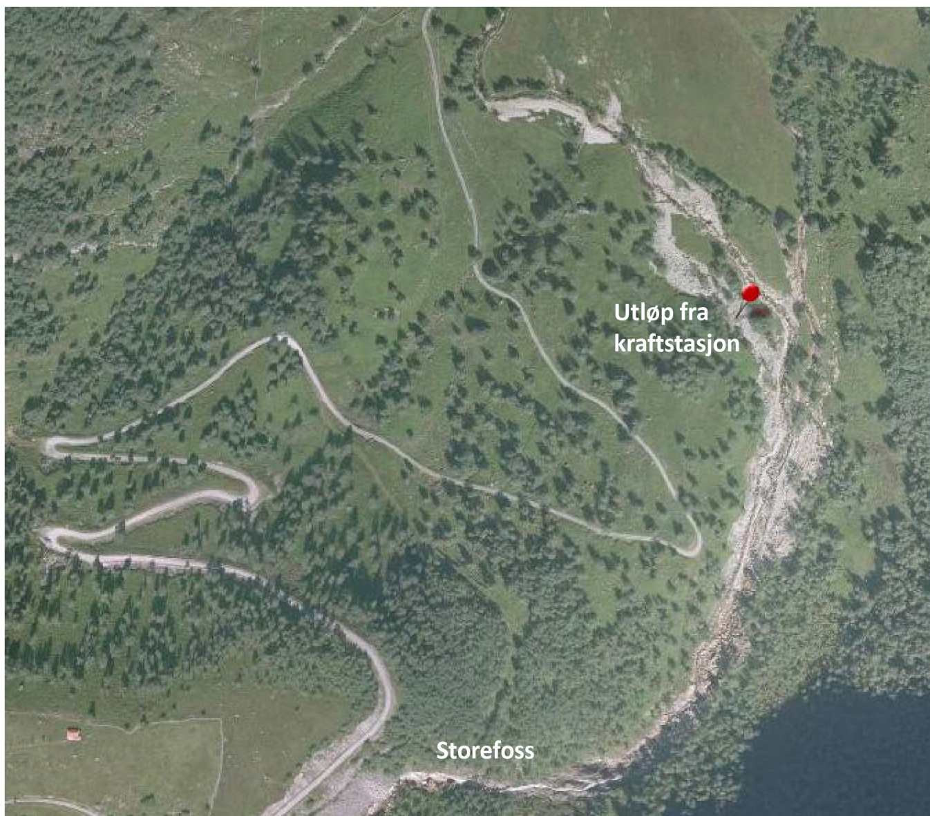
Figur 3.5: Flyfoto som viser Sjørdalselva fra Storefoss til Nedreberg. Vannføringen ved fototidspunktet er lav. Erosjon i løsmassene nedenfor Storefoss har ført til en viss forgreining av flomløp i området ved kraftverksutløpet.
