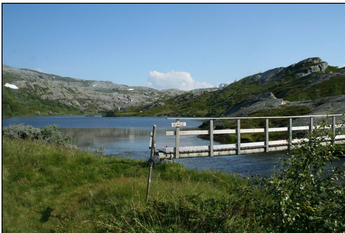
Figur 3. Bildet viser utløpet fra Kumlevann der det planlegges å bygge en lav terskel i betong. Terskelen får en bredde på ca 15 meter.
