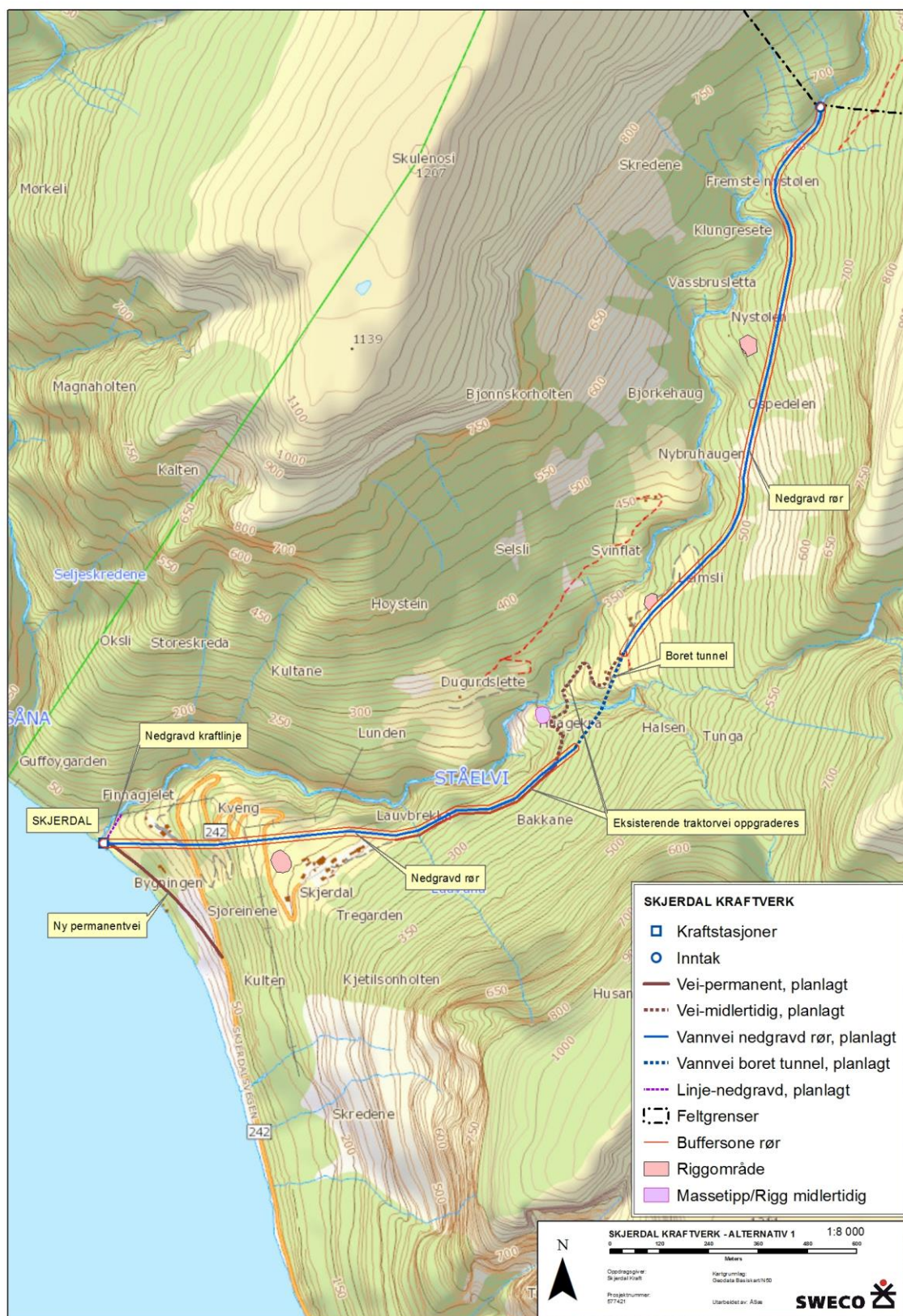
Figur 5. Oversiktskart som syner planlagde fysiske inngrep ved alternativ 1. Rørygate (blå linje) frå hovudinntak ned til kraftstasjon ved fjorden. I midtre delar av inngrepsområdet er eksisterande traktorvegar på nord- og sørsida av elva svakt avmerkte. Kart frå SWECO, Region Trondheim.
