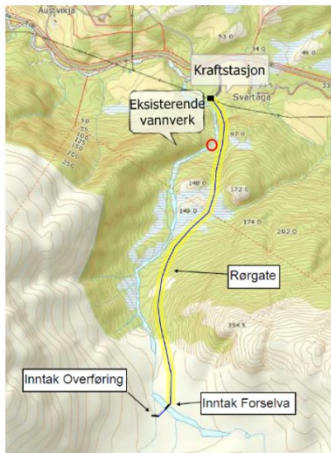
Figur 6. Oversiktskart Forselva kraftverk (fra konsesjonssøknad). Figuren viser planlagt rørgate, inntak, overføring og kraftstasjon (svart boks) (fra konsesjonssøknad).
