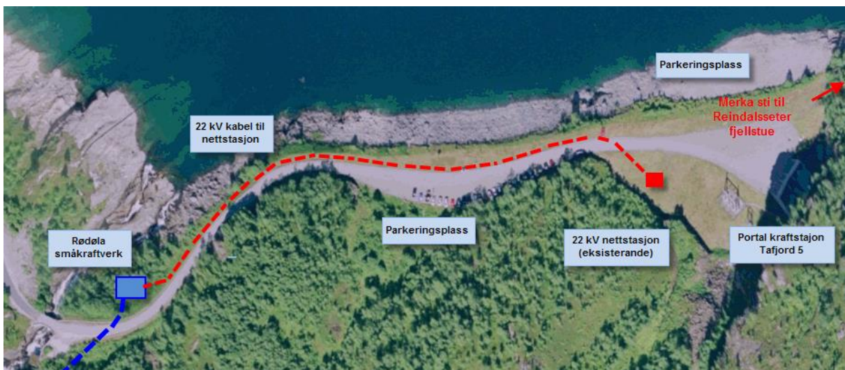
Fig. 3.16.1 22 kV jordkabel mellom Røddøla kraftverk og eksisterande 22 kV netstasjon.
