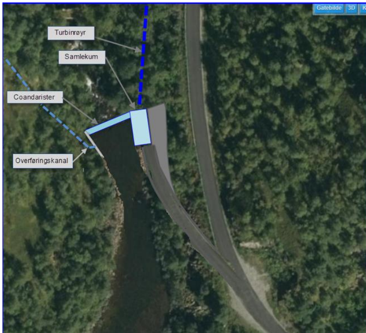
Fig. 2.2.4.5 Coandainntaket teikna inn på luffoto.
