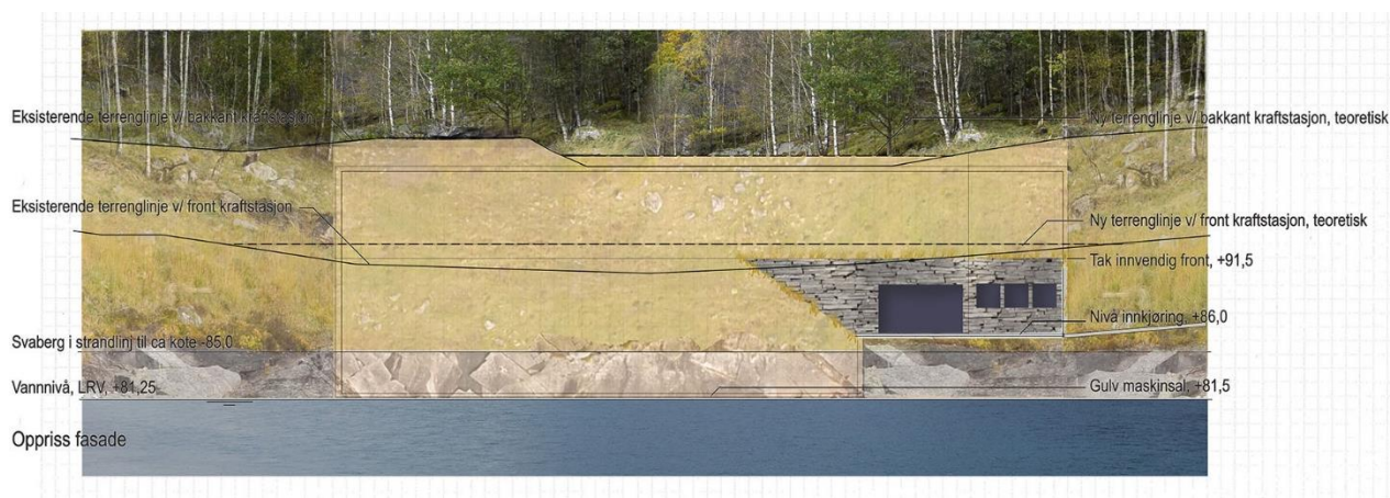
Figur 7 Oppriss som viser begrensa synlig fasade, omtrent som den vil opplevast sett frå sør, på avtrykk etter byggegropa.
