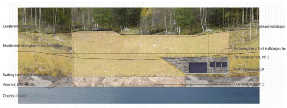
Figur 3: Oppriss, kraftstasjon i dagen, forslag 2 (Multiconsult)
