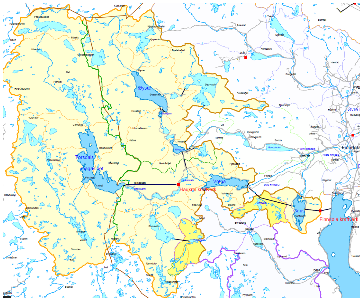
Fig 4.1 Nedbørsfelt til Haukrei og Finndøla kraftverk. Arealene som er merket gult viser nedbørsfeltene som utnyttes i de to kraftverkene.
