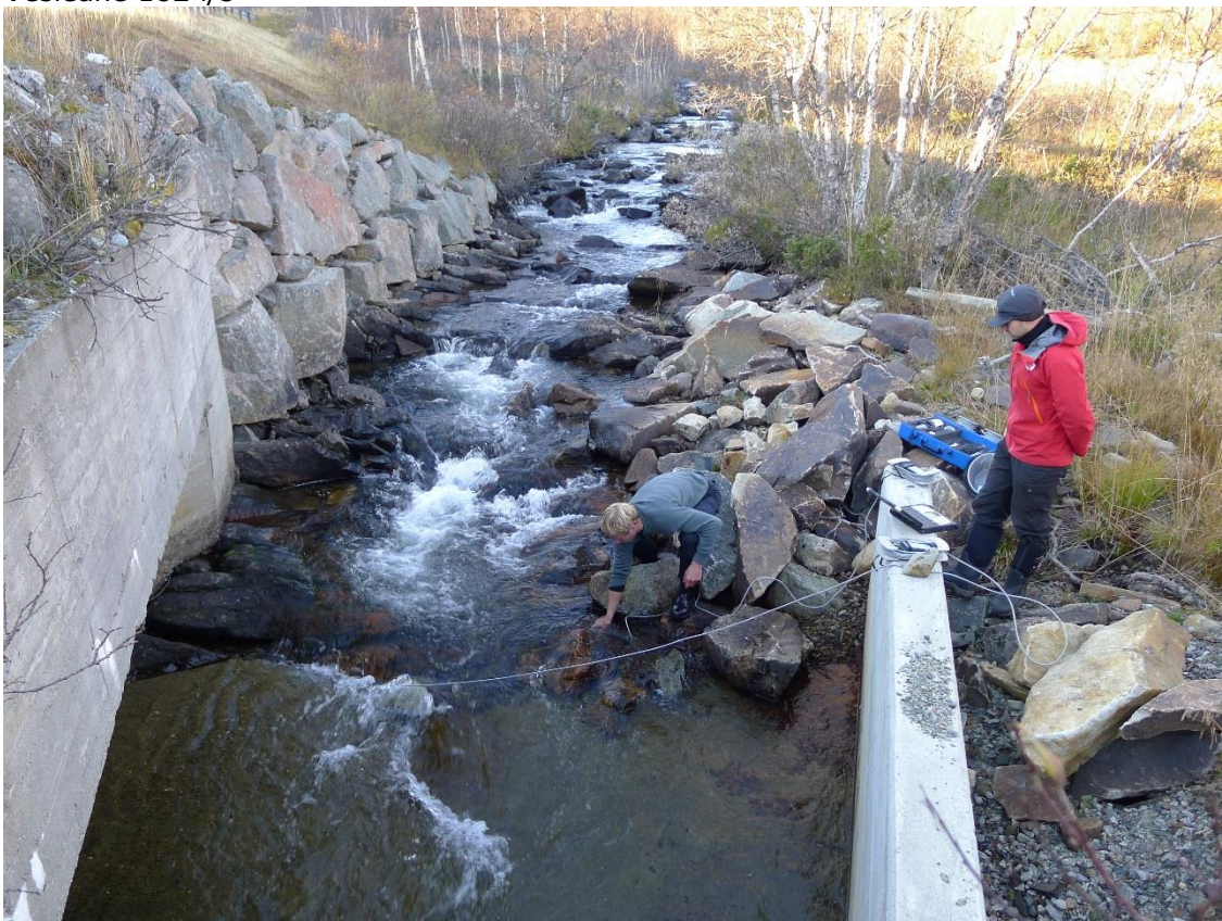
NVE måler vannføringa med saltmetoden
