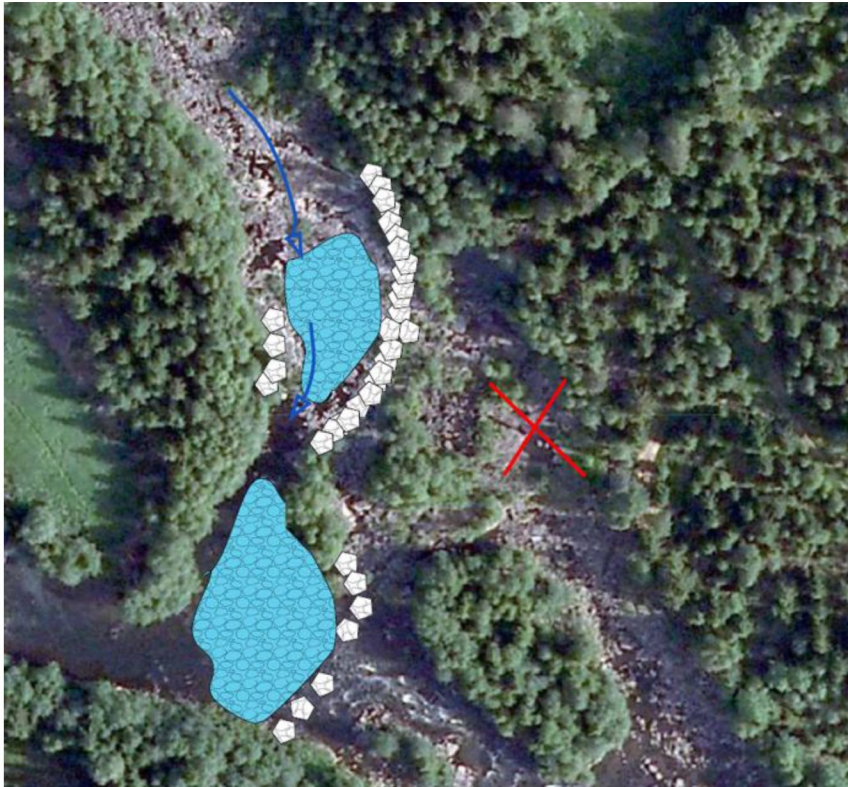
Figur 7. Vannet konsentreres inn mot det vestre / øverste løpet. Østre elveløp stenges av med steiner og tettende masse. Det graves ut masser for å skape en kulp i Storåne. I hovedelva legges det opp blokker for å stue opp vannet og danne en mer markert kulp. Det bør legges ut gyttegrus i sideelva etter nærmere anvisning.
