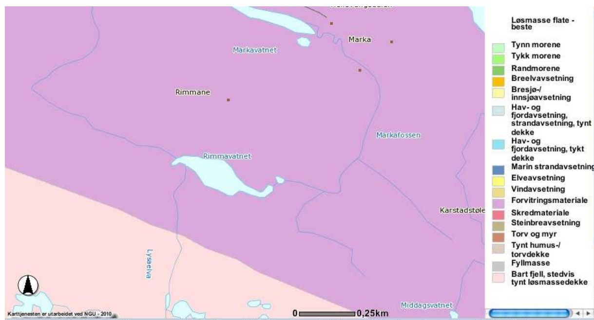
Figur 8. I følge dette lausmassekartet, så er det forvittringsmaterialar i det meste av utbyggingsområdet, heilt øvst ved inntaket er det mest bart fjell med stadvis tynt humusdekke.
