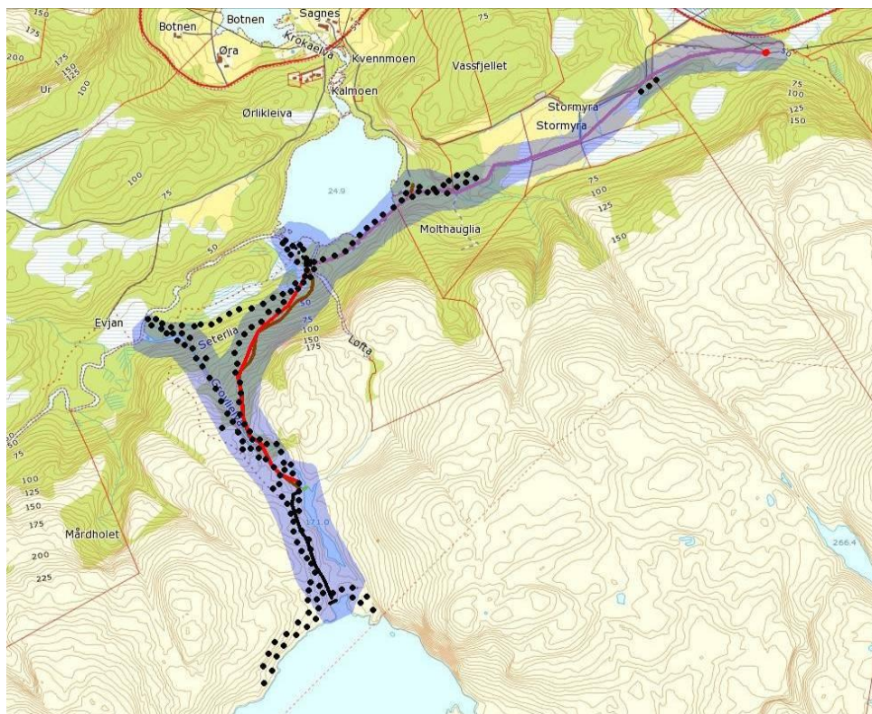
Figur 3.2. Befaringsrute ved feltundersøkelser 13. oktober 2010 (svarte plott). Rød linje er rørgatetrasé, brun er vei til inntak, svart er vei til demning og lilla er kabeltrasé.
