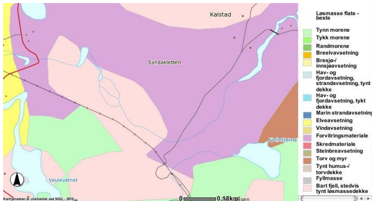
Figur 7. I fylgje dette lausmasekartet så er det mest bart fjell med stadvis tynt lausmassedekke innan de meste av utbyggingsområdet. Øvst er det noko forvittringsmaterialar. (Kjelde: NGU)
