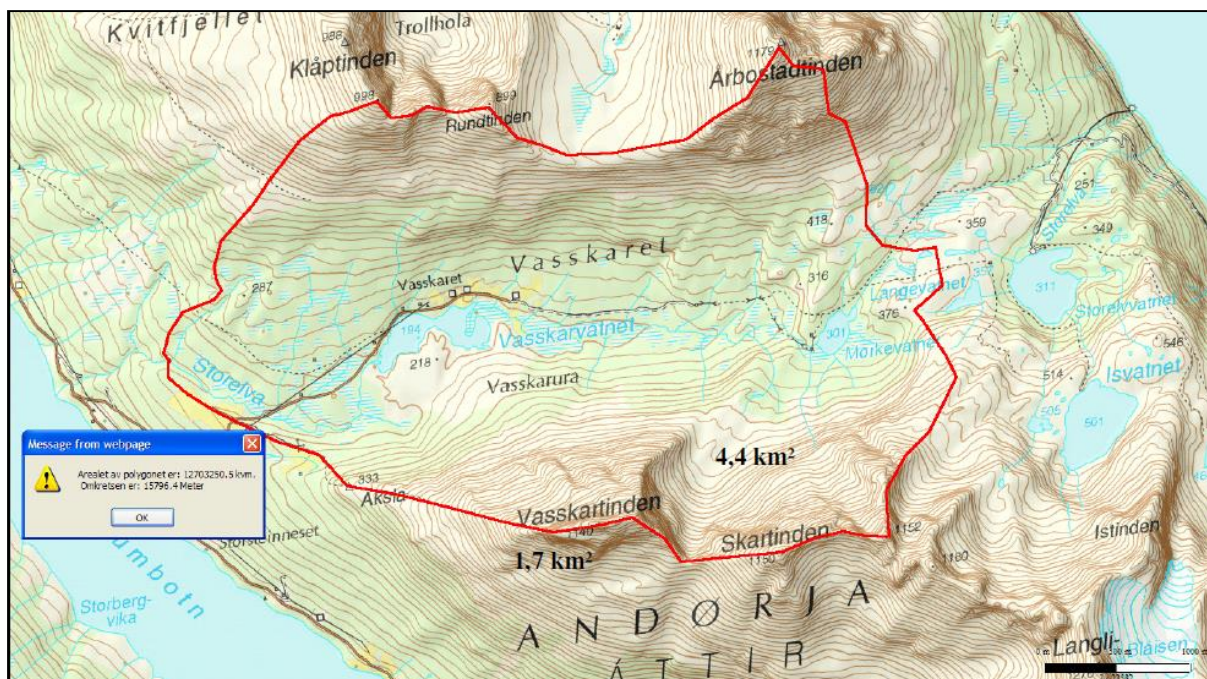
FIGUR 5: OVERSIKT OVER NEDBØRFELTET TIL KRAFTVERKET.
