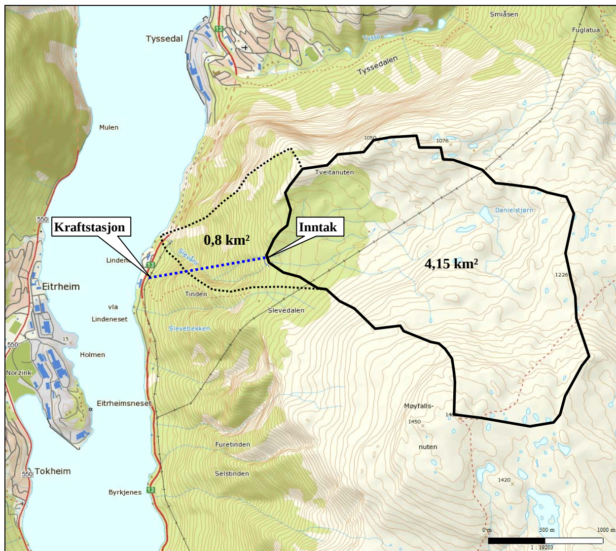
Figur 2 Nedbørfeltet til planlagt inntak og restfelt Sleveåne.
