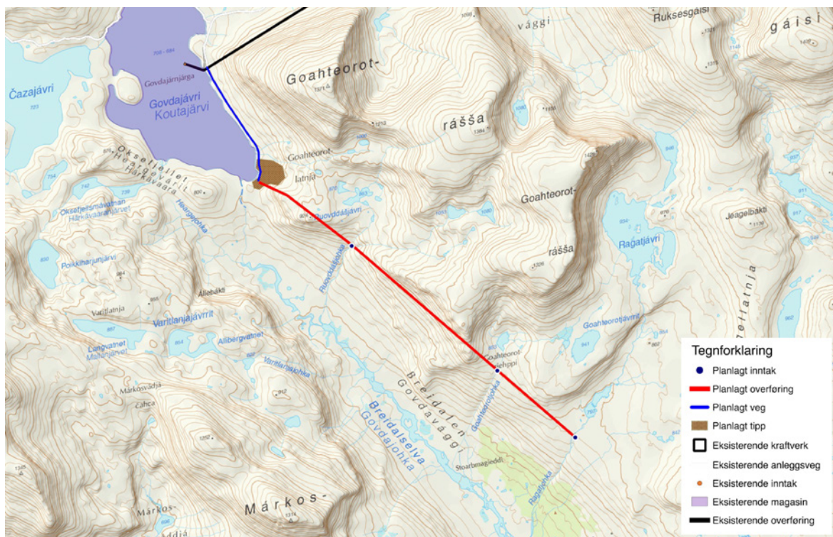
Figur 2 Govdaoverføringen. To alternativer utredet. "Govda 3" har 3 bekkeinntak (hele strekningen) mens "Govda 1" er begrenset til kun ett inntak (nærmest Govdajávri). Kilde: Troms Kraft produksjon AS (tilsendte shapefiler).
