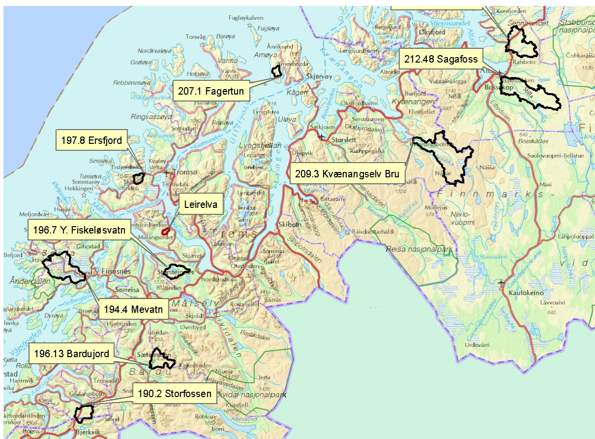
Figur 6 - Kart med inntegnet nedbørfelt til Leirelva kraftverk og sammenligningsstasjoner.
