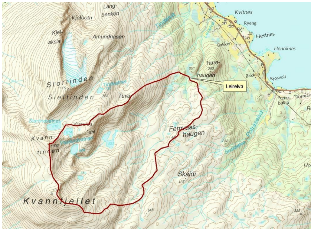
Figur 6: Kartet viser nedbørfeltet til planlagt kraftverk ved inntak (kilde; Småkraftkonsult AS).
